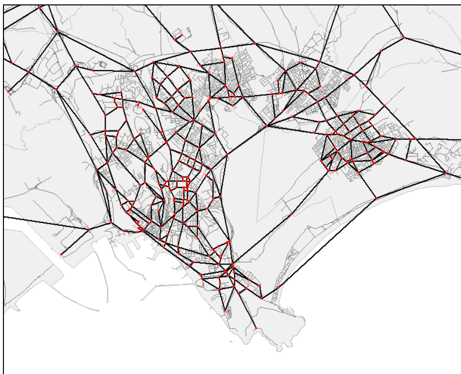
Figura 2.4: Grafo della Rete Stradale della Provincia di Cagliari Ingrandimento sull'Area Urbana di Cagliari
